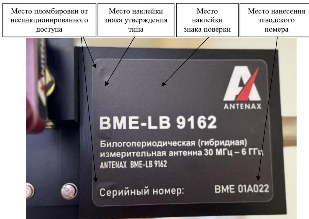
Рисунок 4 – Места нанесения заводского номера, пломбировки, знака поверки, знака утверждения типа
